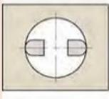
Скруглённые измерительные поверхности для измерения внутренних размеров
